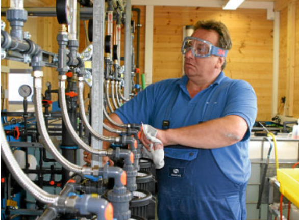
Auf der hauseigenen Teststrecke werden die Ultrafiltrations-Module auf Funktionstüchtigkeit geprüft.
