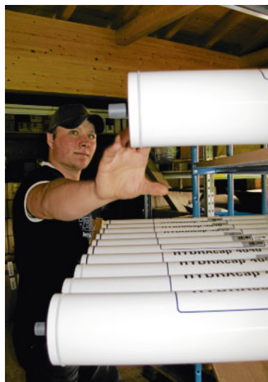
... werden die Membranfaserstränge in Druckrohre eingebracht ...
