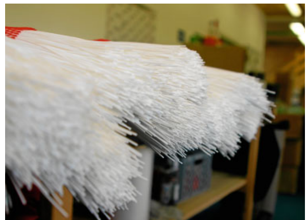
Die Membranfasern bestehen aus für Trinkwasseranwendungen zugelassenem Polyethersulfon.
